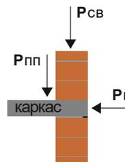
**Pсв** – нагрузка от собственного веса стены, **Pпп** – нагрузка от перекрытий и покрытий, **Pв** – ветровая нагрузка.
